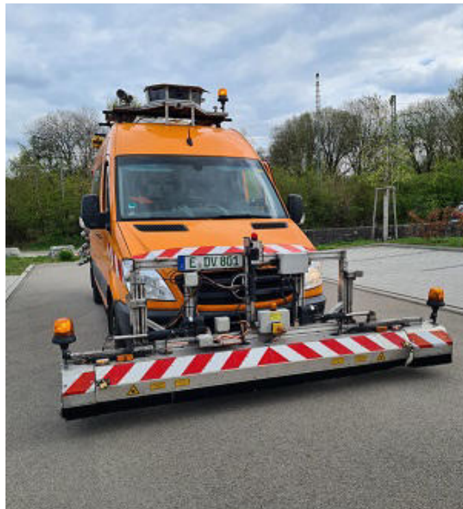
Fahrzeug zur Zustandserfassung der Kreisstraßen
